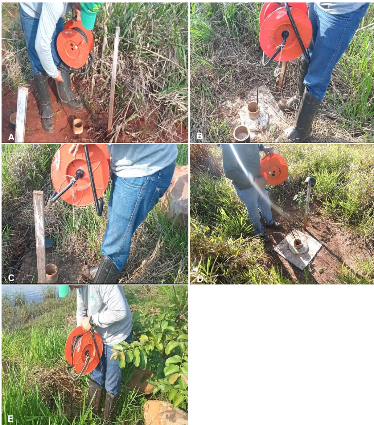
Figura 1 - Poços de monitoramento da CGH Córrego, Chapadão do Sul/MS. A: Poço – Testemunha, B: Poço 01, C: Poço 02, D: Poço 03, E: Poço 04.
