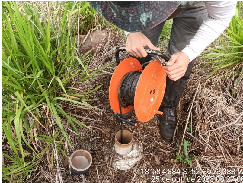
Figura 4 - Equipamento utilizado na medição do nível dos poços de monitoramento.
