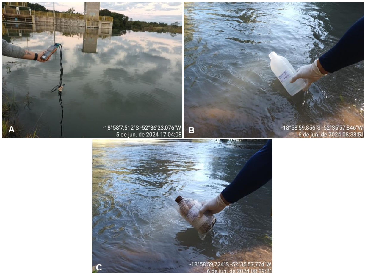
Figura 2 - Procedimentos de amostragem. A: Sonda multiparâmetro; B: Frasco de polietileno para análises físico-químicas; C: Frasco tipo âmbar para análise de Óleos e Graxas e Clorofila-a.
